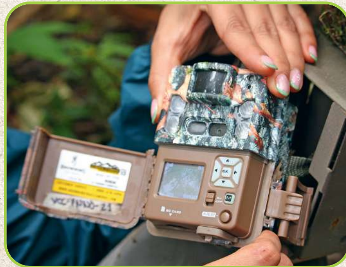
Parte exterior de una cámara trampa.
