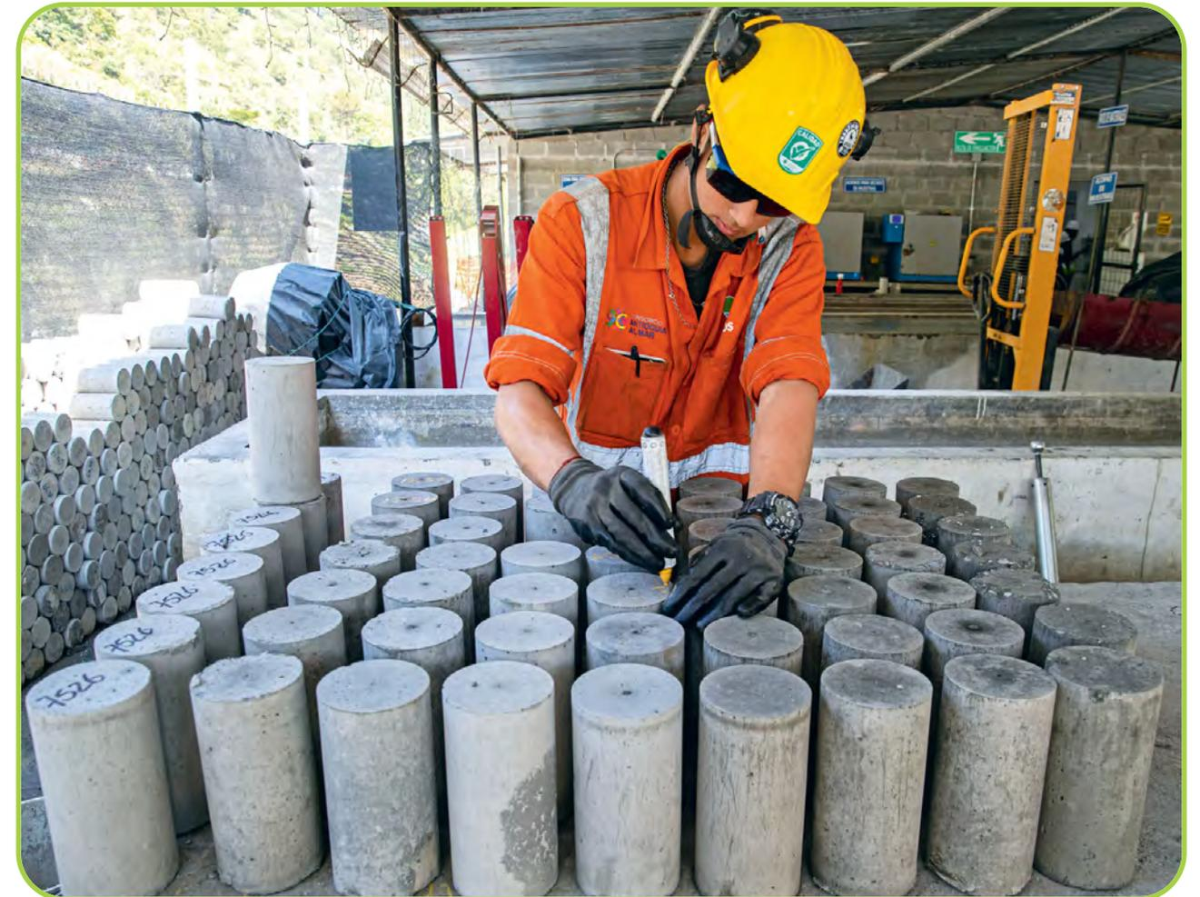
Marcaación de los cilindros para determinar cada muestra.
